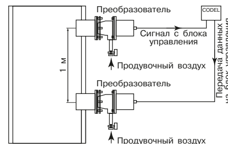
Рис. 5. Типичное расположение датчика расхода V-CEM 5000 компании Codel
