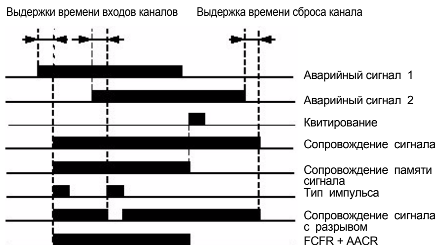
Рис. 3.3.8.-1 Принцип формирования различных типов сигналов повторения. Аварийные сигналы 1 и 2 объединены в один и тот же групповой аварийный сигнал повторения.
