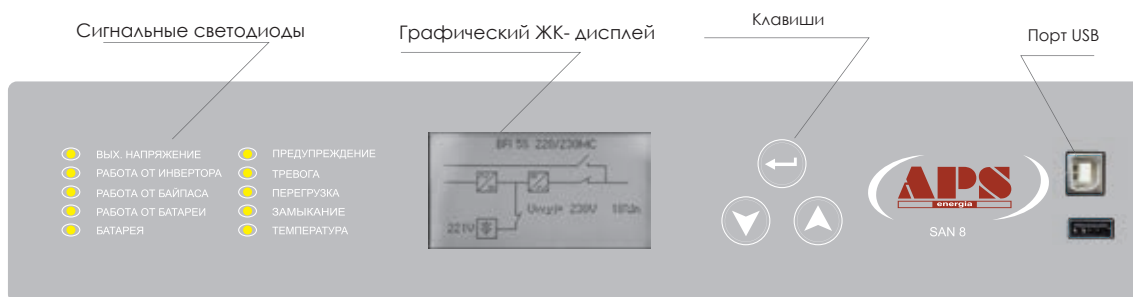
РИСУНОК – КОНСОЛЬ ТИПА SAN 8 В ВЕРСИИ СО СТРЕЛОЧНОЙ НАВИГАЦИЕЙ
