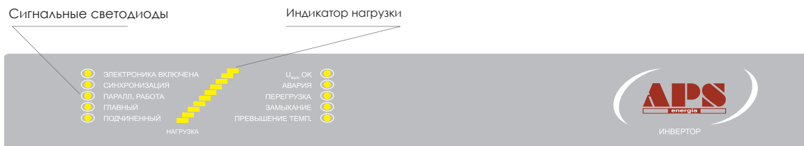
РИСУНОК – КОНСОЛЬ ТИПА SAN 8 В ВЕРСИИ БЕЗ ЭКРАНА ДЛЯ МОДУЛЕЙ В МНОГОМОДУЛЬНЫХ СИСТЕМАХ С ОБЩИМ КОНТРОЛЛЕРОМ
