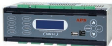
РИСУНОК – ВНЕШНИЙ ВИД СИСТЕМЫ НАДЗОРА ТИПА SAN 5
