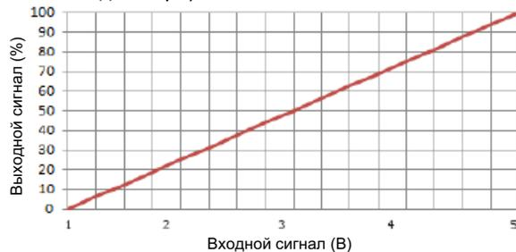
Рисунок 9. Линейный выходной сигнал.
