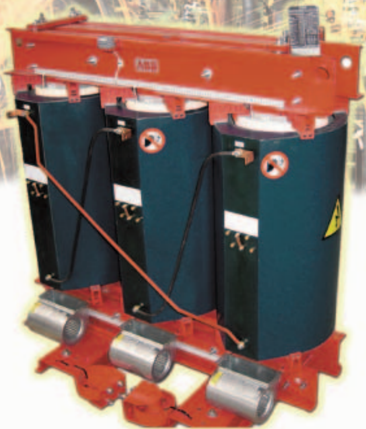
Трансформаторы с вентиляторами естественного/нагнетаемого воздуха, с охлаждением вентиляторами, направляющими воздух в охладительные каналы. Увеличение мощности до 50%.
