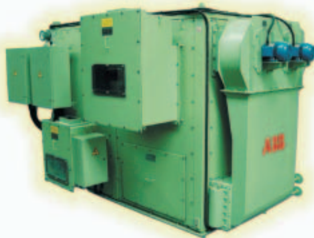
Сухие трансформаторы АББ с литыми обмотками в морском исполнении. Система водяного охлаждения AFWF (принудительное воздушное/принудительное водяное – «air forced/water forced»). Конструкция и производство одобрены морским регистром «Ллойд», «Бюро Веритас», DNV, RINA, ABS.
