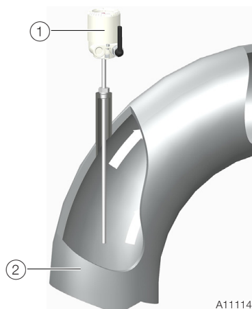
Рис. 5 ① SensyTemp TSP300-W ② Технологическая труба
