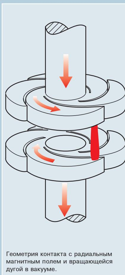
способность и прерывания тока короткого замыкания, вакуумное прерывание кабелей.
