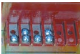
Вторичная коробка зажимов (2 обмотки и заземляющий зажим)
