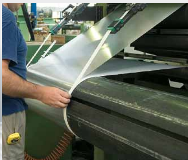
Изготовление обмотки низкого напряжения
