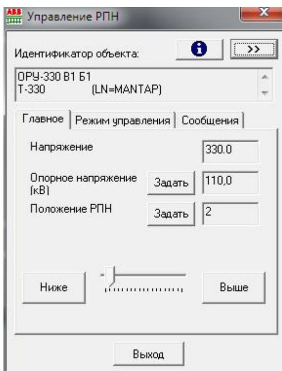
Рис. 4.6.-1 Окно управления устройством РПН
