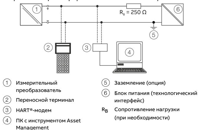
Рис. 32. Пример подключения HART®
