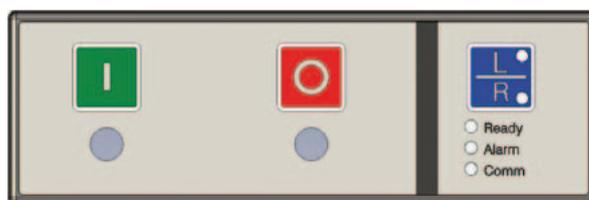
Состояние работы выключателя может отображаться непосредственно на лицевой стороне 3 светодиодами, находящимися на локальном интерфейсе (HMI) или же дистанционно, при помощи бинарных выходов. Кроме того, при помощи HMI можно переключать управление выключателя с дистанционного на локальный режим (кнопка L/R).
