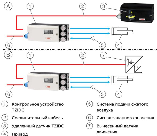
Рис. 3: TZIDC с внешними датчиками движения
