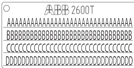
Рис. 2. Дополнительная крепежная табличка из нержавеющей стали с данными заказчика, которая прикрепляется с помощью проволоки
