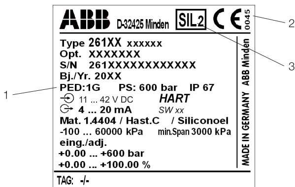
Рис. 3: Маркировка в соответствии с директивой по оборудованию, работающему под давлением (пример) 1 PED: 1G | 2 Кодовый номер органа, контролирующего соответствие директиве по оборудованию, работающему под давлением | 3 Маркировка „SIL 2“ (опция)
